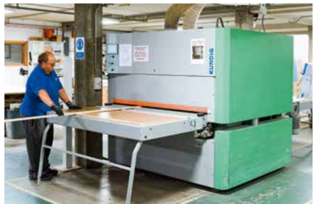
Die Kündig Brilliant-2 1600-RCd hat eine serienmäßige Arbeitsbreite von 1600 mm und ist eine Ergänzung der großen Botop.
