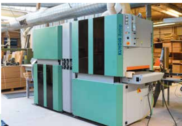
Insgesamt sechs Schleifaggregat ermöglichen bei der Kündig Technic Botop-6 650-RRR-RRR die beidseitige Bearbeitung.
