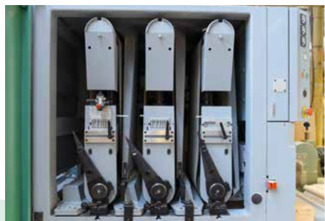
Die Bestückung mit drei Körnungen erlaubt es, in einem Durchgang von der gehobelten zur fertigen Oberfläche zu kommen.
